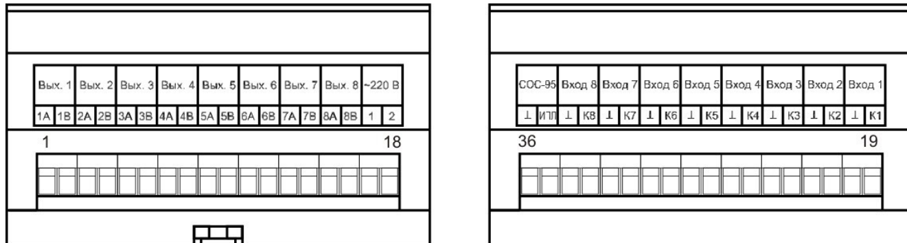
Рисунок 4 - Маркировка контактов разъемов БИУ-DIN
